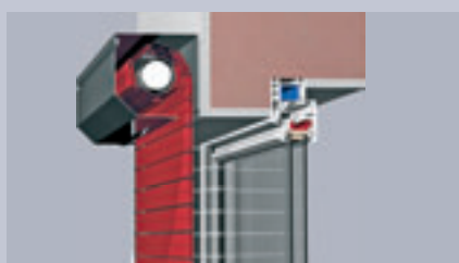
Fassadenmontage (Typ C)
